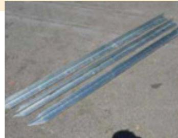
Fabrika ve sanayi tesisilarının inşaatına başlanmadan önce tesis sahnesinin zemini, Alpmet topraklama seridi ve klemenslerle öndürerek topraklama alt yapısı oluşturulur. Sanayi tesisi faaliyete geçtikten sonra kullanılacağı elektrik enerjisinin topraklama sistemi fabrikannın altyapısında önemli bir yer tutar.
